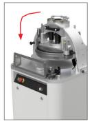
3. Закройте узел резки, сопроводив его до опоры и закройте крепежные толкатели (x2)
