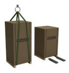
В целях транспортировки машину можно упаковать на поддоне, в коробке или ящике. Упакованную этим образом машину можно поднимать при помощи автопогрузчика или тележки для поддонов, вставив зубцы вил в специальные отверстия под упаковкой. Либо ее можно поднять при помощи крана, продев тросы или стропы под упаковкой. В этом случае соблюдайте максимальный угол натяжения тросов, который должен быть равен 45°, как показано на рисунке.
