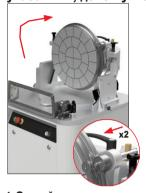
1. Откройте узел резки, сопроводив его до опоры. Извлеките крепления кольца (х2)
