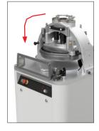
6. Закройте узел резки, сопроводив его до опоры
